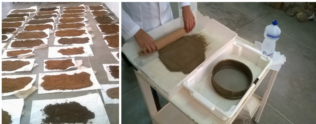
Figura 19: Preparo das amostras de solo para análise química e para fins de fertilidade.
